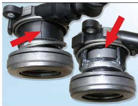
Рис 5: CSC поврежден из-за неправильной установки
